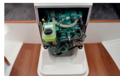
Le moteur Saildrive D1 de 20 chevaux de Volvo Penta présente de bonnes dimensions et fournit en tout temps au bateau la poussée dont il a besoin. 50 litres de diesel assurent une bonne autonomie. L'accès à l'agrégat est bien réalisé: l'escalier de trois marches de l'entrée peut être entièrement enlevé en quelques gestes. Au vu de son caractère très sportif, le J/111 est bien évidemment équipé en standard d'une hélice pliable.
